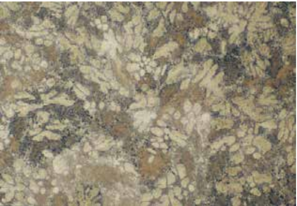
Zinc-Aluminum Alloy, 200X B.F. (etchant CrO 3 , Na 2 SO 4 )
